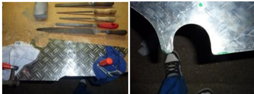
Und schon erwartet mich das nächste Problem. Wie soll ich das jetzt biegen? Das Material ist viel zu hart um es einfach so zu biegen. Also nehme ich den Winkelschleifer und schneide eine Kerbe in das Blech hinein. Anschließend fülle ich den Spalt mit Spezialsilikon aus, dies führt zu mehr Stabilität.
