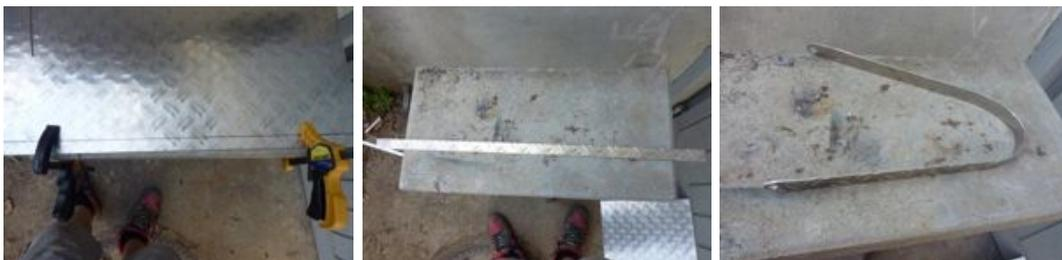
Bei den Seitenschützern zeichne ich zuerst einen groben Umriss auf das Riffelblech und danach säge ich es mit der Stichsäge aus.
